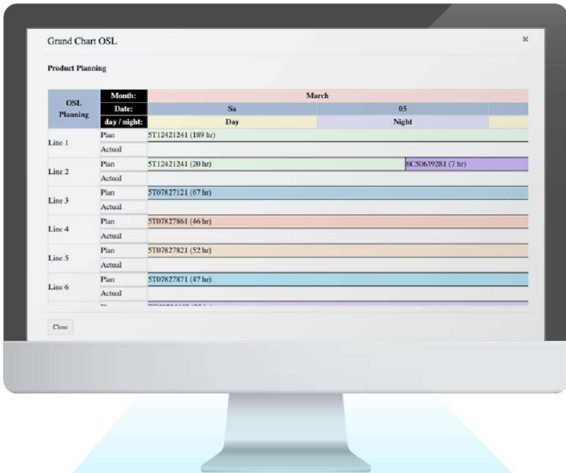
Figure 4 ตารางแผนการผลิต (Production planning) ของแต่ละไลน์การผลิต/เครื่องจักรผู้ใช้งานสามารถปรับแต่งแผนเพื่อให้เวลาเดินการผลิตถูกใช้อย่างเต็มประสิทธิภาพ
